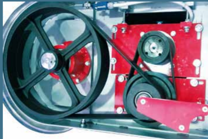
Doppia trasmissione spirale su Linea LYNX-R / Double spiral transmission on LYNX-R Line
